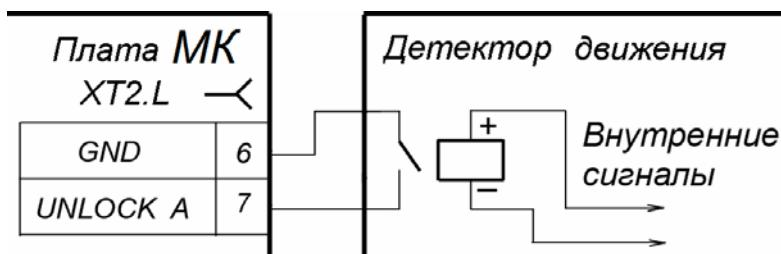
**Рисунок 7.Управляющий элемент детектор движение – нормально разомкнутый контакт реле**
